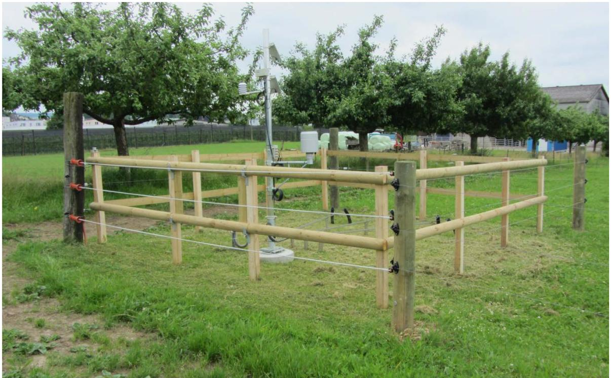
**Pro Aluminiumschiene je ein Tensiometer in 20 und 35 cm Bodentiefe.**
