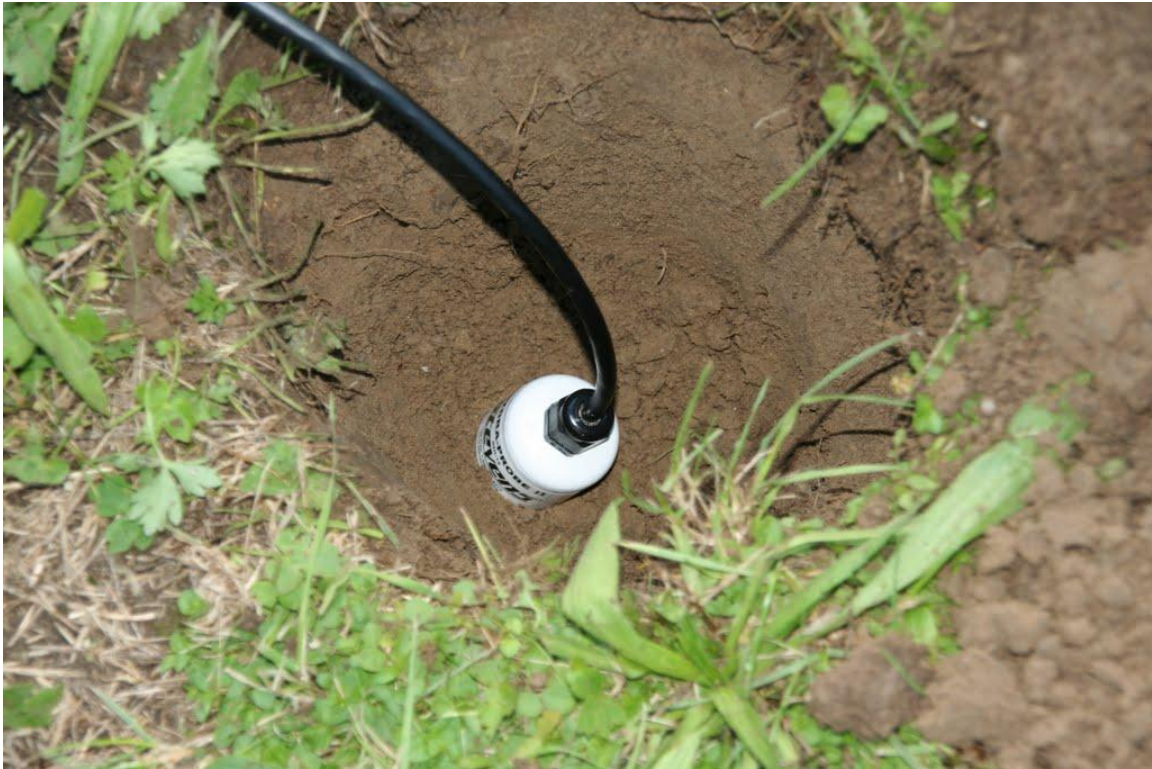
Eingebaute Stevens-Sonde zur Messung des Wassergehaltes
