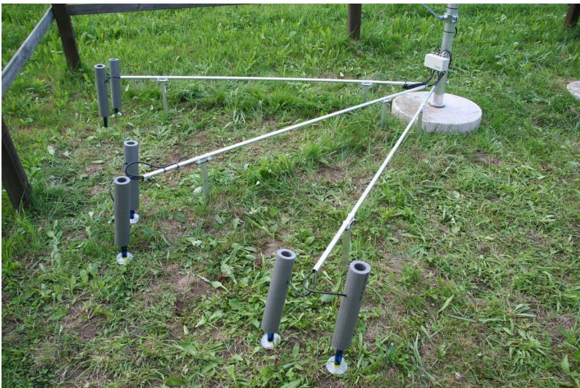
Übersicht der 3 x 2 Tensiometer
